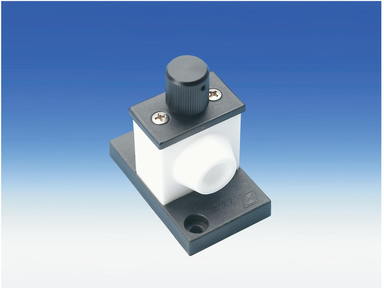
Bei Anwendungen in meß- und regeltechnischen Anlagen ebenso wie in der Analysen- und Labortechnik, sind Nadelventile aus PTFE zur Feinregulierung unverzichtbar. Dieses Nadelventil ist vorgesehen zur Durchflußfeinregulierung hoch aggressiver Medien. Durch die präzise Anpassung der Spindel an den Ventilsitz ist eine sehr feine Einstellung möglich. Die Ventile können für gasförmige und flüssige Medien eingesetzt werden.
