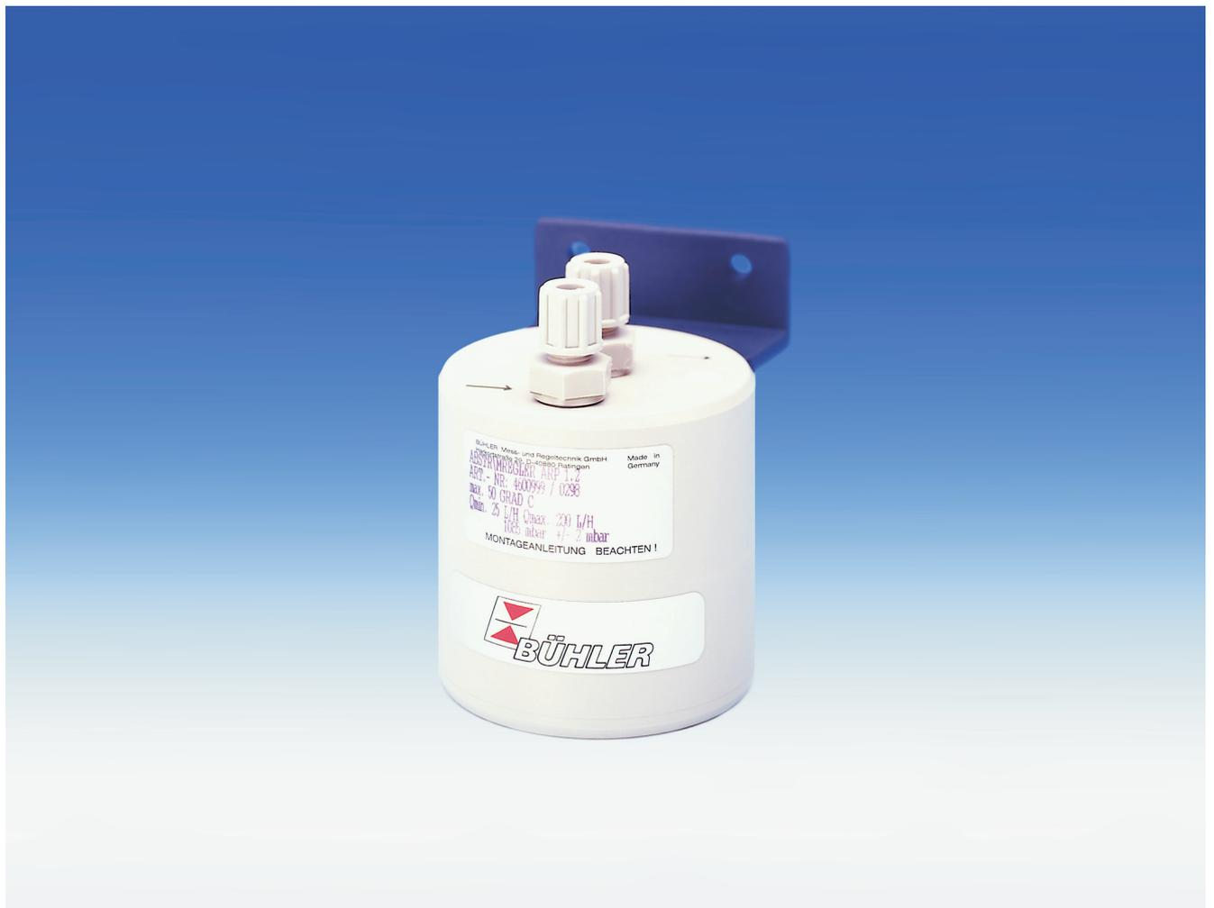
Der Abströmregler dient zur Konstanthaltung des Meßgasdruckes im Analysator, unabhängig vom jeweiligen Barometerstand und wird im Gasausgang des Analysators eingebaut.
