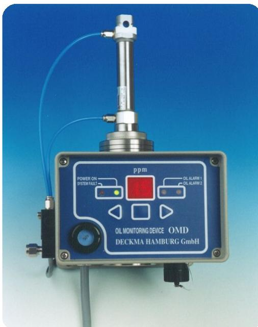
OMD-15A mit automatischer Zellenreinigung
