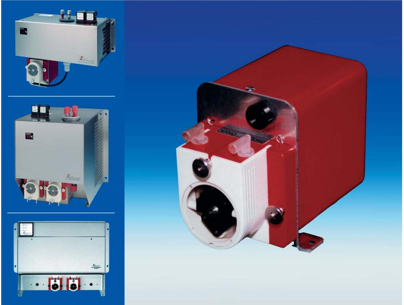
Die Ableitung von Kondensat aus geschlossenen Gassystemen erfordert den Einsatz spezieller Ableitungssysteme. Wird das Analysensystem im Unterdruckbetrieb gefahren, ist der Einsatz von peristaltischen Pumpen besonders vorteilhaft. Sie gewährleisten den Abtransport des Kondensats bei gleichzeitiger Abdichtung des Systems.
