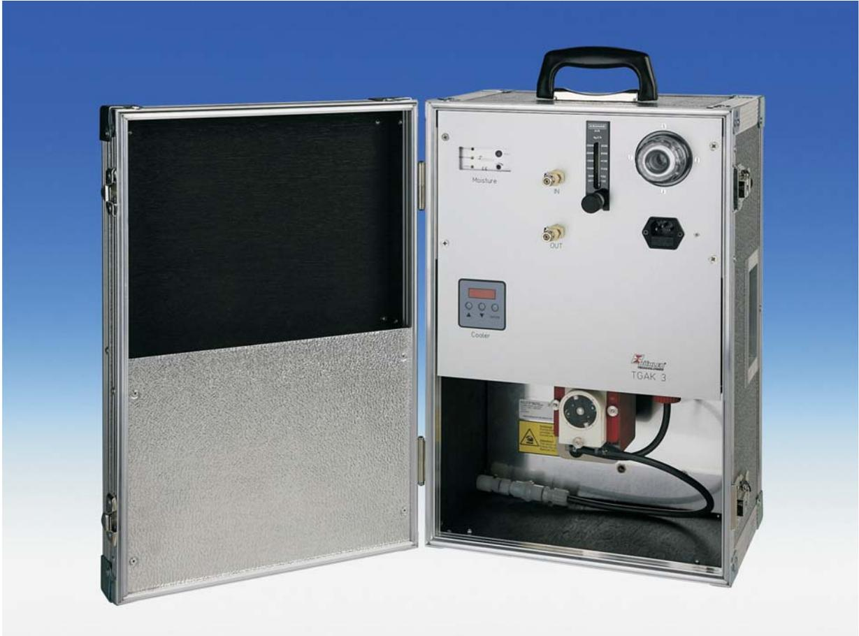
Die Durchführung genauer und sicherer Gasanalysen an wechselnden Einsatzorten erfordert ein kleines kompaktes Gasaufbereitungssystem. Für diese Anwendung wurde in einem stabilen Koffer ein vollständiges Messgasaufbereitungssystem geschützt untergebracht.
