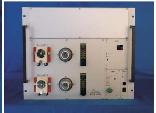
Bei der Analyse eines Gases ist es wichtig, das Gas vor der Zuführung in den Analysator aufzubereiten. Hierbei sind Komponenten wie Gaskühler, Gaspumpe, Filter, Kondensatpumpe und Strömungsmesser notwendig. Weitere Funktionen - wie z.B. die Zuführung von Kalibriergasen - können je nach Anwendung erforderlich sein.
