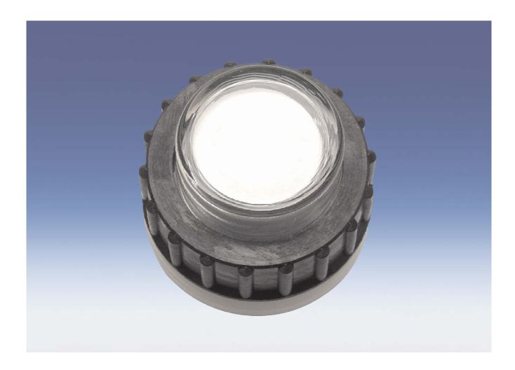
Der Filter AGF-FE 4 wurden speziell für den Frontplatteneinbau in Analysatoren oder Systeme entwickelt. Der Grundkörper wird an der Frontplatte befestigt. Die Glasglocke wird mit einer Überwurfmutter auf den abdichtenden O-Ring gedrückt. Für alle medienberührenden Teile wurden beständige Materialien gewählt. Das Filterelement selbst besteht aus gesinterten PTFE.
