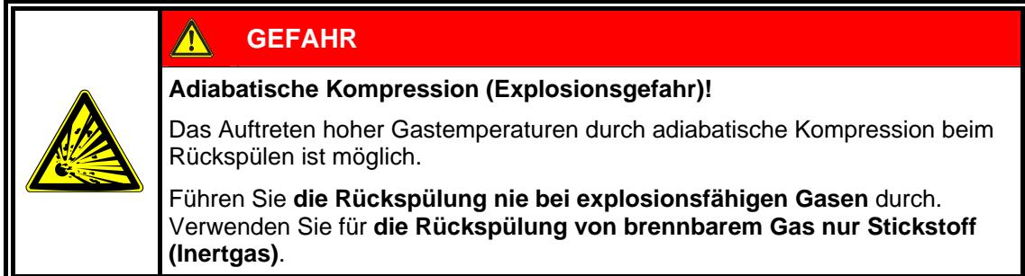
Das Auftreten hoher Gastemperaturen durch adiabatische Kompression beim Rückspülen ist möglich. Sonden mit Rückspülung sind nur für die Entnahme von nicht explosivem Gas geeignet. Die Rückspülung von brennbarem Gas darf nur mit Stickstoff (Inertgas) erfolgen!
