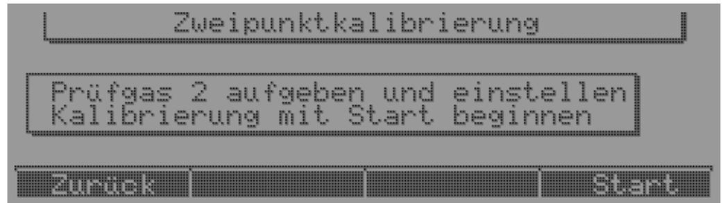
Abbildung 37 Aufforderung zum Start des 2. Teils der Kalibrierung (System ohne Pneumatikeinheit)
