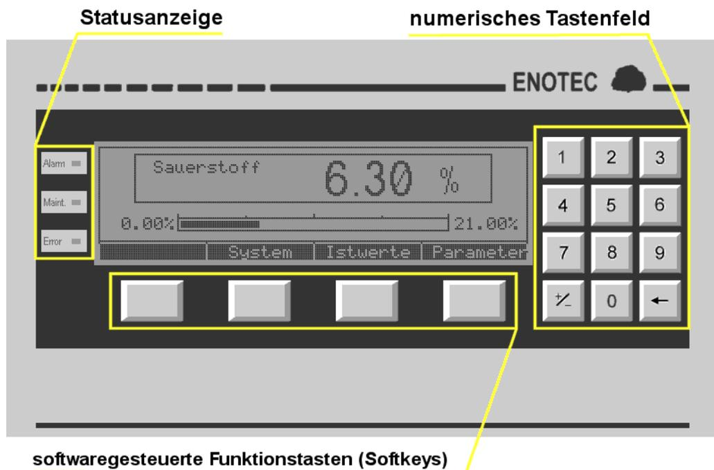
Abbildung 19 Frontplatte der OXITEC<sup>®</sup> ECONOMY Auswerteelektronik
