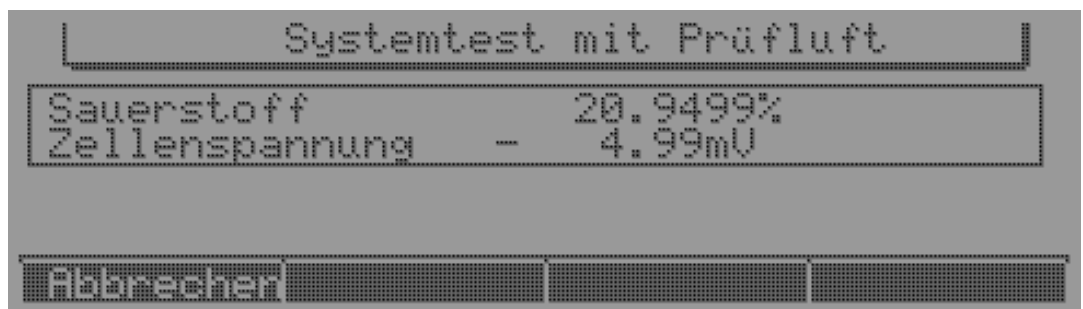
Abbildung 50 Displayanzeige: Systemtest mit Prüfluft (System ohne integrierte Pneumatik)
