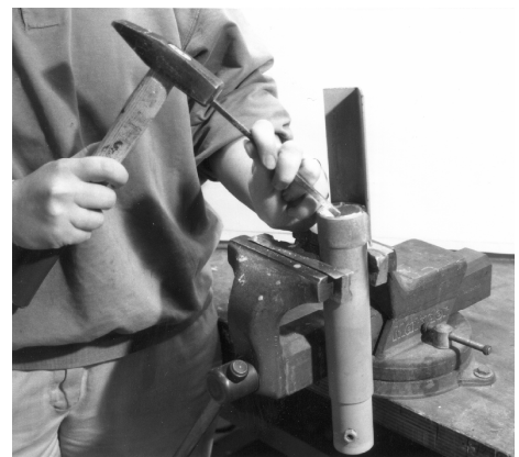
Abbildung 59 Demontage des Filters
