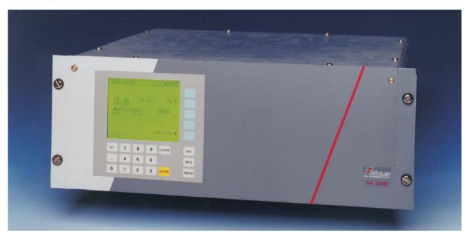
Die Gasanalysengeräte BA 6000 - IR arbeiten nach dem NDIR-Zweistrahl-Gegentaktverfahren und messen hochselektiv Gase, deren Absorptionsbanden im Infrarot-Wellenlängenbereich von 2 bis 9 $\mu$ m liegen, wie z.B. CO, CO<sub>2</sub>, NO, SO<sub>2</sub>, NH<sub>3</sub>, H<sub>2</sub>O, CH<sub>4</sub> und andere Kohlenwasserstoffe.
