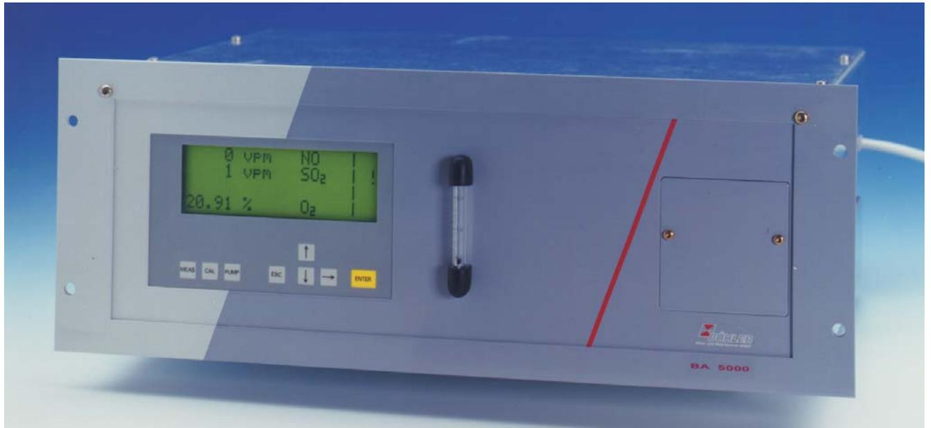
Das Gasanalysengerät BA 5000 ist zur kontinuierlichen Messung von Gaskonzentrationen wie z.B. CO, CO<sub>2</sub>, NO, SO<sub>2</sub>, CH<sub>4</sub> geeignet. Bis zu drei dieser Komponenten sowie zusätzlich O<sub>2</sub> können mit dem Analysator gleichzeitig gemessen werden.
