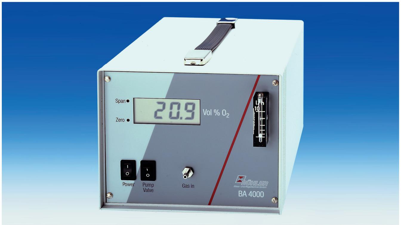
Der tragbare Bühler O<sub>2</sub> - Analysator Typ BA 4000 wird für Stichprobenmessungen in Prozessanlagen eingesetzt. Der BA 4000 kann mit den Optionen interne Messgaspumpe, 2 Alarmkontakte oder Gehäuseschutzart IP54 konfiguriert werden.
