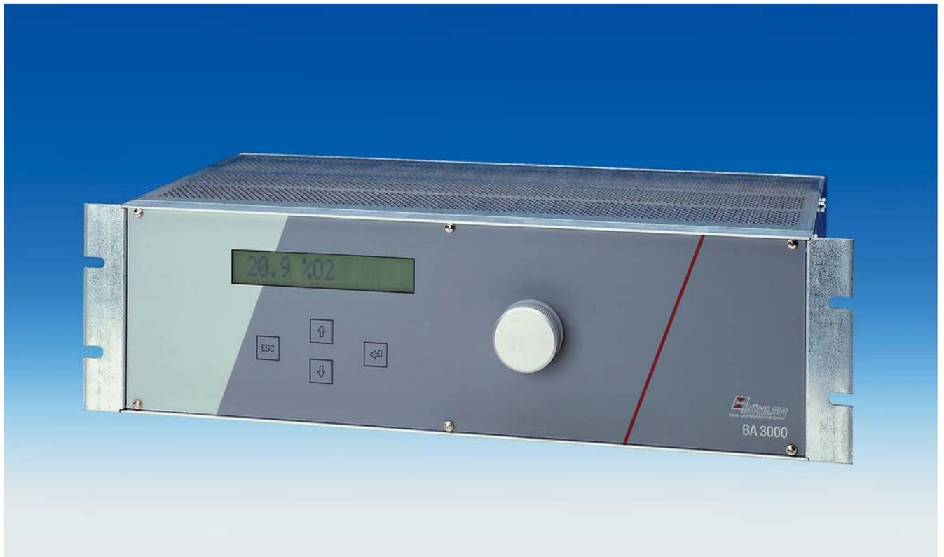
Das stationäre Gasanalysengerät BA 3000 ist zur kontinuierlichen Messung der Sauerstoffkonzentration in Gasgemischen geeignet. Das Analysengerät kann zur Prozess- und Sicherheitsüberwachung sowie zur Emissionskontrolle eingesetzt werden. Der Analysator arbeitet nach dem paramagnetischen Hantelmessprinzip, welches die starken paramagnetischen Eigenschaften von Sauerstoff ausnutzt.
